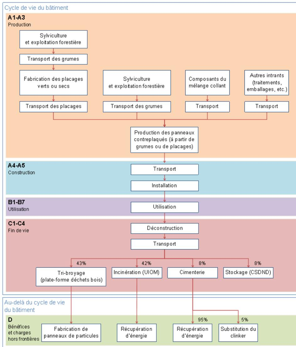
Note : ce schéma est générique, se rapporter à la description du produit type et des principaux constituants pour plus de détails.
